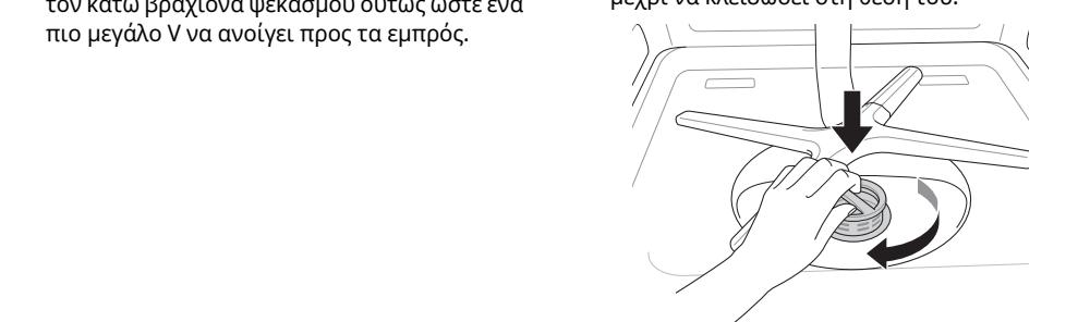
**2** Γυρίστε το εσωτερικό φίλτρο αριστερόστροφα και βγάλτε το συναρμολογημένο εσωτερικό φίλτρο και το φίλτρο ανοξείδωτου χάλυβα.
