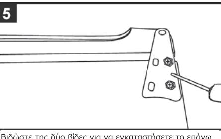
Βιδώστε της δύο βίδες για να εγκαταστήσετε το επάνω στήριγμα. Σπρώξτε την πόρτα για να κουμπώσει στον επάνω μεντεσέ. Τοποθετήστε το πλαστικό κάλυμμα επάνω στον μεντεσέ, και κουμπώστε το.
