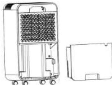
4. Όταν χρησιμοποιείτε σωλήνα νερού για συνεχή αποστράγγιση, η έξοδος δεν πρέπει να βυθίζεται σε νερό για να αποτρέψει το μπλοκάρισμα.
