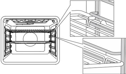
Για τους οδηγούς σχάρας, τοποθετείτε πάντα τη σχάρα και τα ταψιά μέσα στην υποδοχή μεταξύ του πάνω και του κάτω τμήματος κάθε οδηγού.
