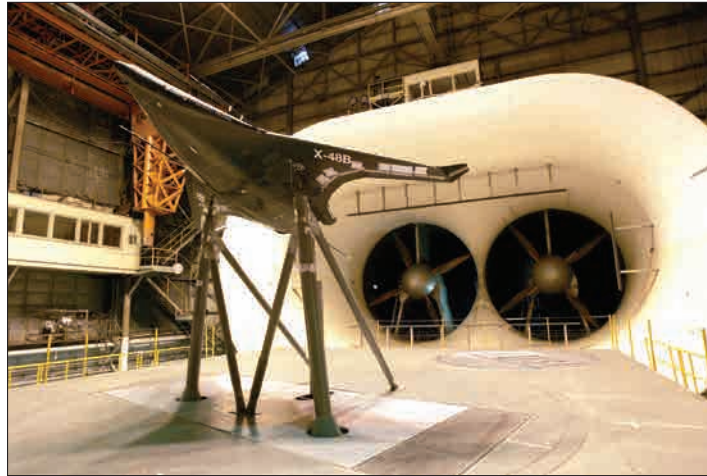
Εικόνα 3.10: Τοποθέτηση μοντέλου αεροσκάφους στην περιοχή μετρήσεων μεγάλης υποχητικής αεροδυναμικής σήραγγας.
