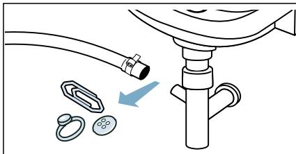
4. Τοποθετήστε ξανά τον εύκαμπτο σωλήνα άντλησης και ασφαλίστε το σημείο σύνδεσης χρησιμοποιώντας τον οφιγκτήρα του εύκαμπτου σωλήνα.
