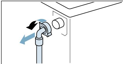
2. Χρησιμοποιήστε τοιμπίδα για να αφαιρέσετε το φίλτρο.
